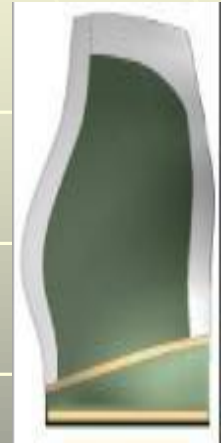
GE90-115B 128 ins fan diameter 22 blades 1,019 lbs fan weight
