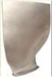
CFM56-7B 61 ins fan diameter 24 blades 260 lbs fan weight
